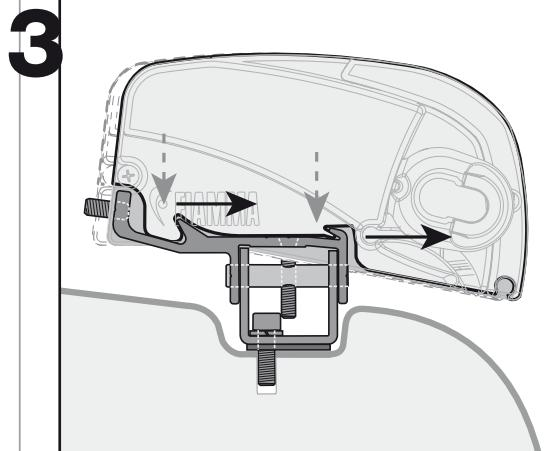
**DE** Vor dem Anziehen der Schraube, die Position der Markisen kontrollieren, welche das komplette Öffnen der Schiebetür ermöglichen muss.
