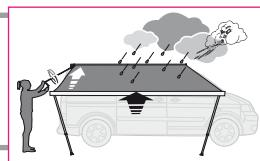
**DE** Um die Halterungen, nicht sinnlos zu belasten, müssen - nach ungefähr 1 m Auszug - die Stützbeine auf den Boden gesetzt werden.
