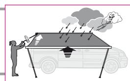
**CZ** Aby nedocházelo ke zbytečnému zatěžování konzol, doporučujeme rozložit podpěrné nohy ve vzdálenosti 1m od otevírání.
