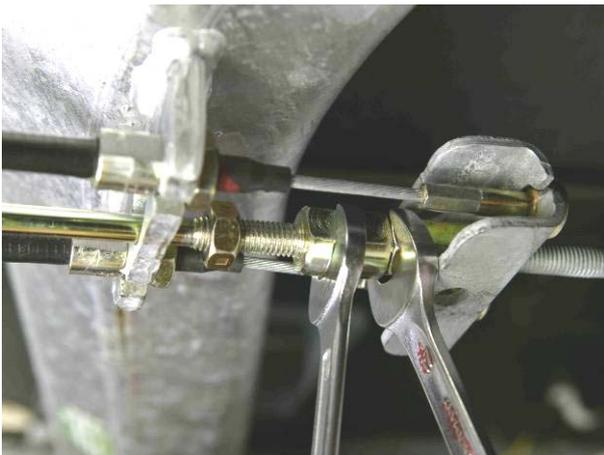
3. Führungsbolzen (5) auf Gestänge aufdrehen und kontern.
