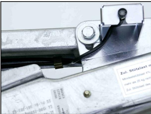
2. 6kt-Mutter an der Auflaufeinrichtung lösen und LED-Halter einschieben.
