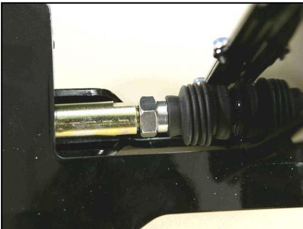
6. Druckstangenverlängerung so weit wie möglich in ATC einschrauben.
