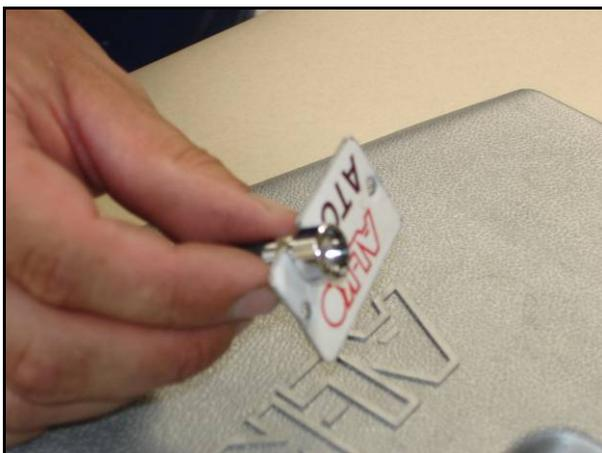
6. LED durch Bohrung Ø13,5 mm am Kunststoffcover stecken und Halteblech montieren.
