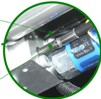
Bemerkung: Entfernen Sie die Schutzhülse welcher über die Nippeln platziert sind kurz vor der eigentlichen Installation der Notbetriebs Handpumpe, dieses um unnötigen Schaden von den Nippeln zu vermeiden
