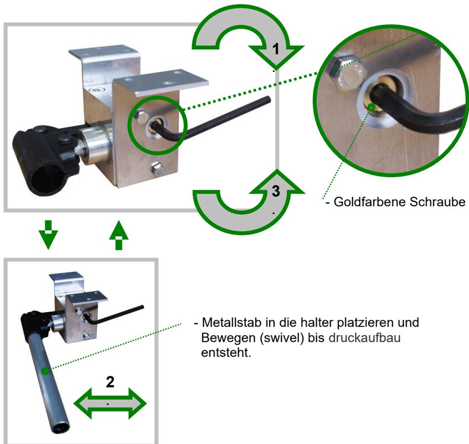
Anschließend füllen Sie den Ölreservoir mit Öl und schließen Sie die Hydraulikpumpe. (Öl nachfüllen, bis das Öl aus die Pumpe läuft)
