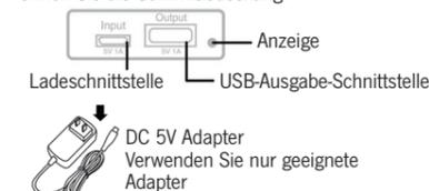
Die grüne Anzeige blinkt, wenn der Akku geladen wird, das grüne Licht leuchtet, wenn der Akku voll ist. Wird USB-Ausgangsschnittstelle zum Laden externer Geräte verwendet, leuchtet die Anzeige rot. Die Anzeige blinkt, wenn der Strom abgeschaltet ist.
