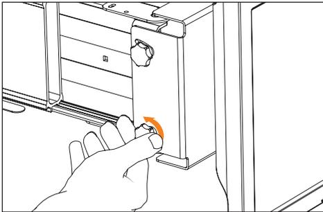
Zum Neigen des **Halters** müssen Sie zuerst die beiden **Kunststoffschrauben** an der **Halteplatte** etwas lösen.
