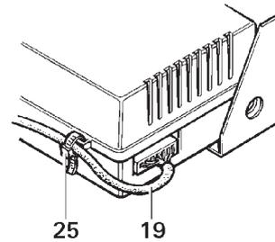
Som strekkavlastning skal betjeningsdelens kabel (19) sikres på styreelektronikken ved hjelp av den vedlagte kabelbinderen (25).
