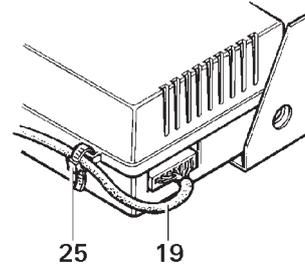
Säkra manöverdelskabeln (19) vid det elektroniska styrregulatet med den bifogade kabelbindningen (25) för att undvika dragbelastning.
