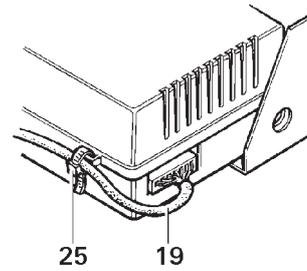
Kiinnitä käyttöosan kaapeli (19) ohjauselektronikkaan mukana toimitettua vedonpoistimena toimivaa kaapelinjatkosta (25) käyttäen.
