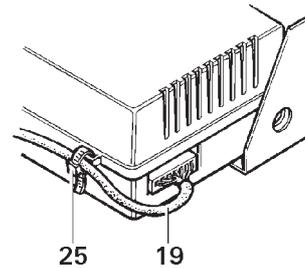
Als Zugentlastung das Bedienteilkabel (19) mittels beiliegendem Kabelbinder (25) an der Steuerelektronik sichern.
