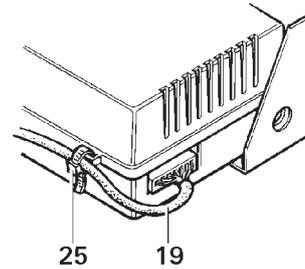
Per eliminare la trazione, fissare il cavo dell'unità di comando (19) al dispositivo elettronico di comando con il fermo fornito (25).
