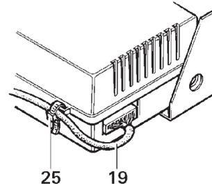
Jako reduktor naprężenia zabezpieczający kabel elementu obsługi (19) wykorzystać załączoną opaskę (25), mocując kabel do urządzenia elektroniki sterowania.
