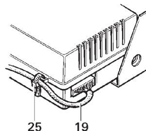
Als trekontlasting van de kabel van het bedieningselement (19) door middel van de ingesloten kabelbinder (25) aan de regelelektronica beveiligen.
