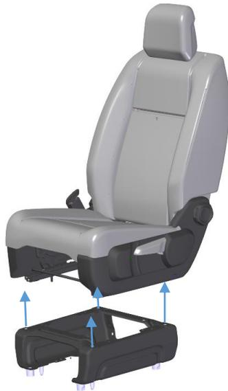
Um dem Sitz zu demontieren, müssen die Elektro-Anschlüsse unter dem Sitz gelöst werden. Anschließend die 4x Schrauben des Originalsitzes, in den Sitzschienen die zur Befestigung des Sitzes auf dem Sitzkasten dienen entfernen.
