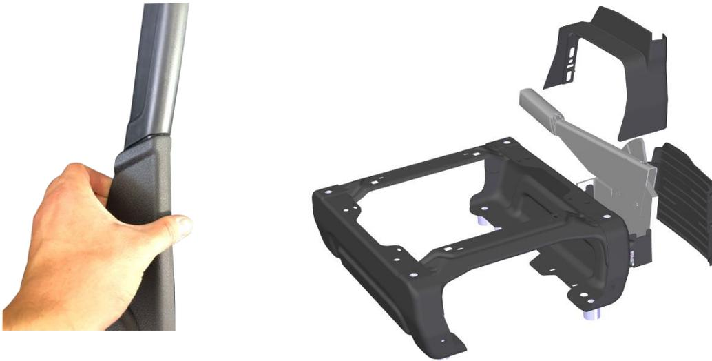
Zuerst muss die Handbremse Demontiert werden.
