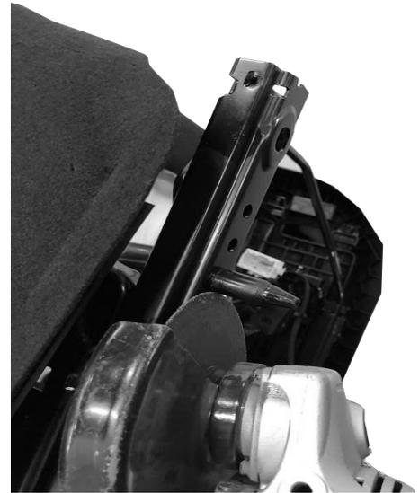
Nun muss der Bolzen / die Bolzen an den Sitzschienen entfernt werden. Die Bolzen müssen so kurz wie möglich abgeschnitten werden, aber ohne dass die Sitzschiene Beschädigt wird.
