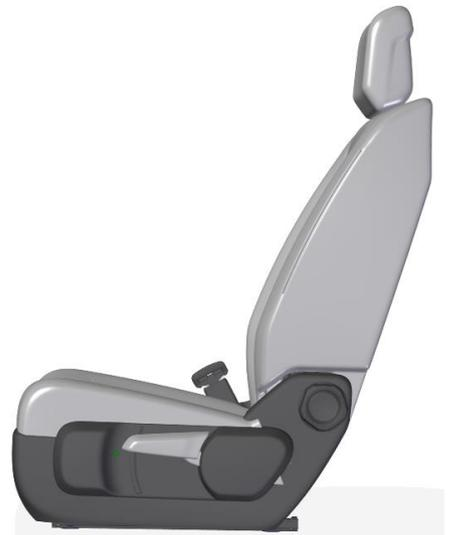
Die Kunststoff-Verkleidung der Sitze muss beschnitten werden, damit sich der Sitz drehen lässt. **Die Kunststoff-Verkleidung muss von unten gemessen ca. 50mm abgeschnitten werden.**
