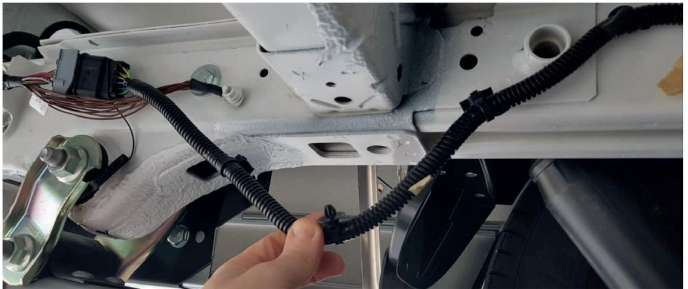
Mueva el cableado eléctrico hacia un lado e inserte el adaptador.
