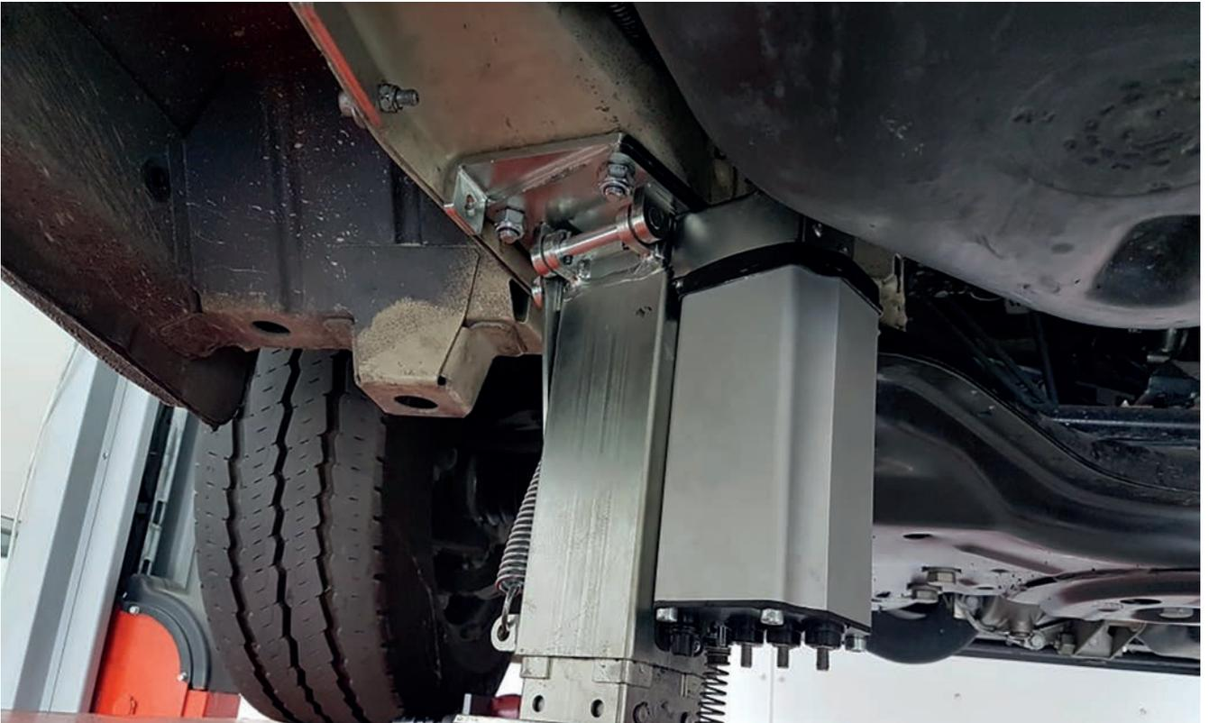
Falls erforderlich, lösen Sie die Schrauben, die den Tank halten, und verschieben Sie ihn einige Zentimeter in Richtung Fahrzeugmitte.
