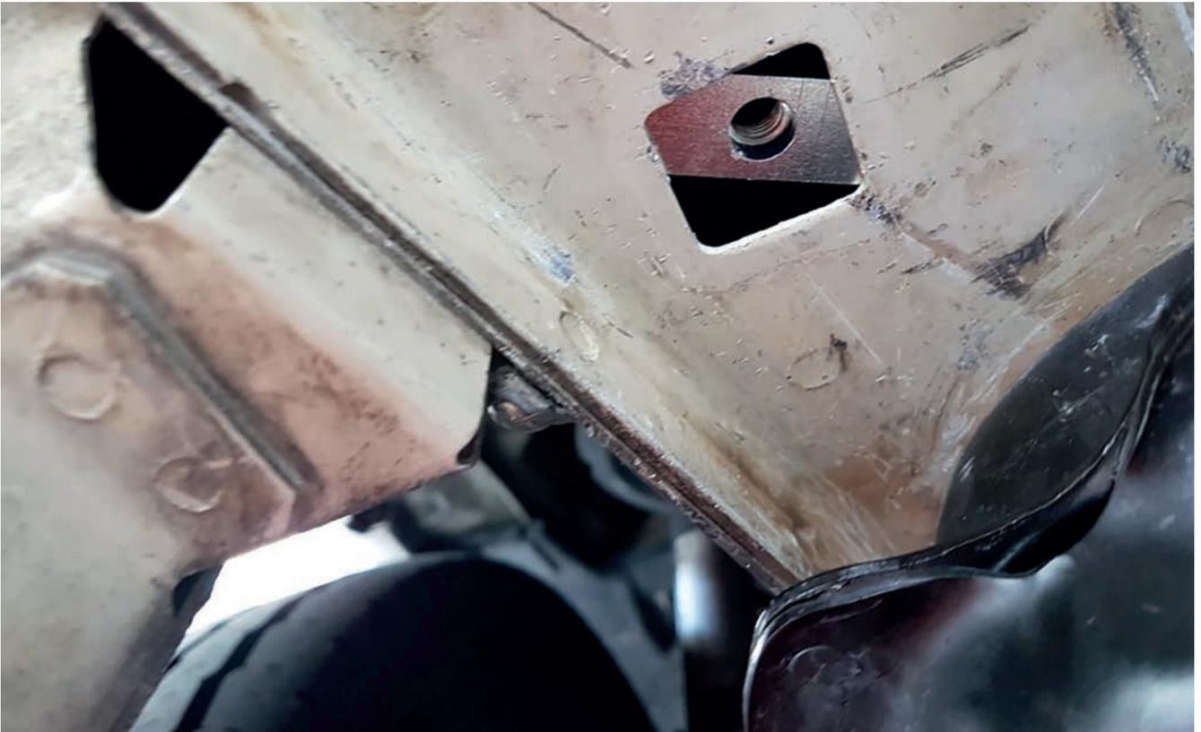
Setzen Sie die Montageplatte so ein, dass das Gewinde konzentrisch zum Vierkantloch sitzt.
