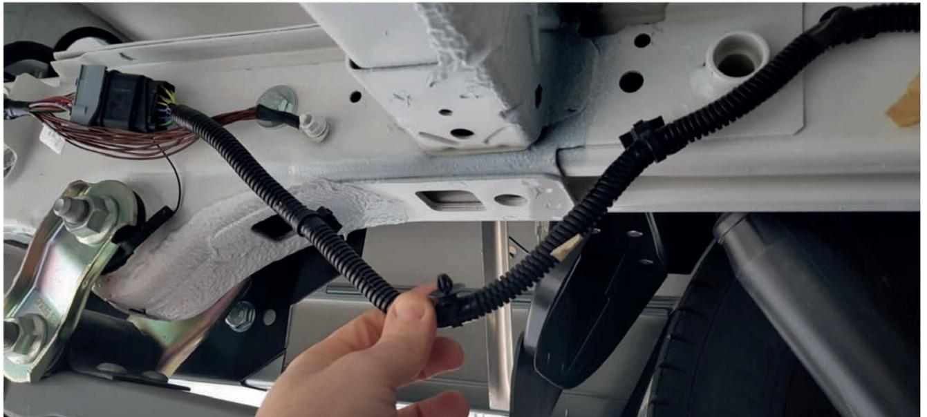
Schieben Sie die elektrische Verkabelung zur Seite und setzen Sie dann den Adapter ein.
