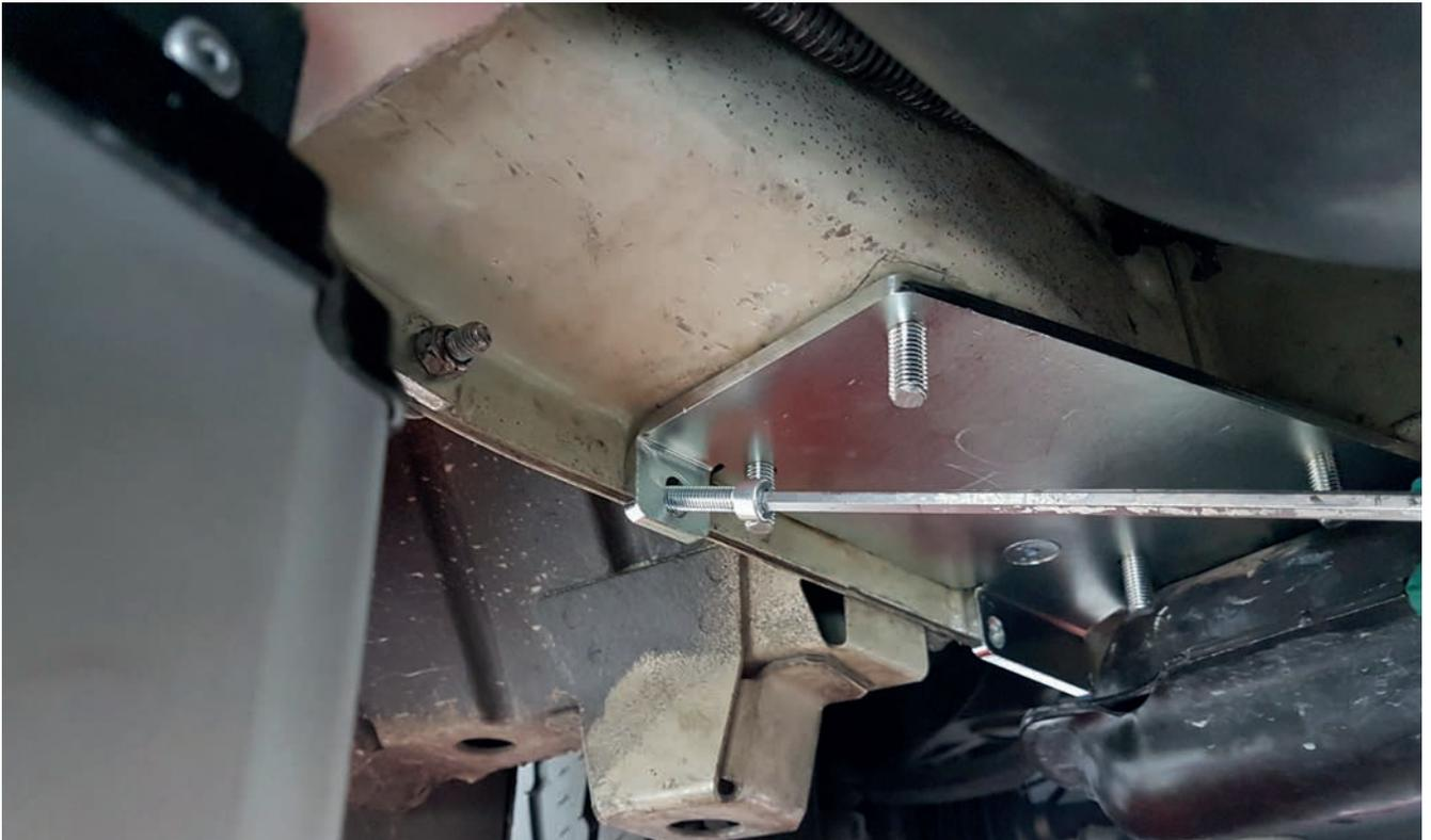
Bevestig de adapterplaat met twee M8-bouten op het chassis.
