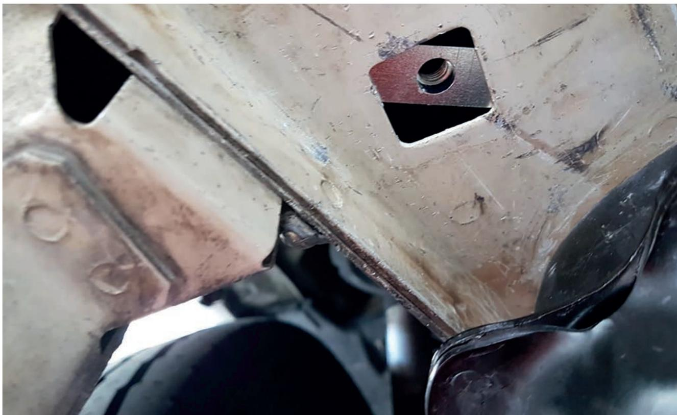
Inserire la piastra di montaggio con il foro della vite concentrico al foro quadrato del telaio.
