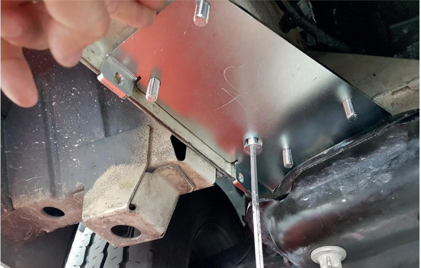
Fije el adaptador con la placa de montaje que ha introducido en el orificio.
