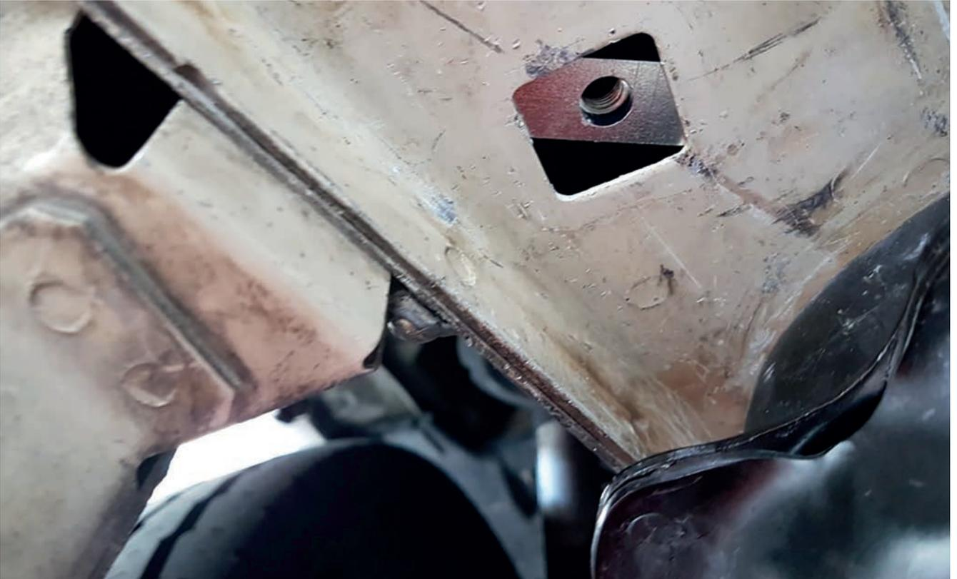
Inserte la placa de montaje con el orificio del tornillo concéntrico al orificio cuadrado del chasis.
