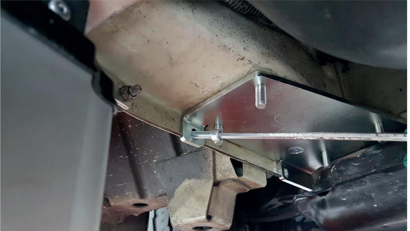
Montieren Sie die Adapterplatte mit zwei M8-Schrauben am Fahrzeuggestell.
