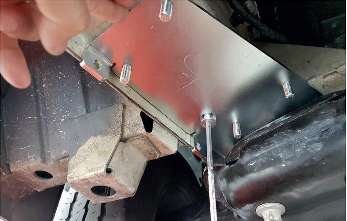
Befestigen Sie den Adapter mit der Montageplatte, die Sie in die Bohrung eingesetzt haben.
