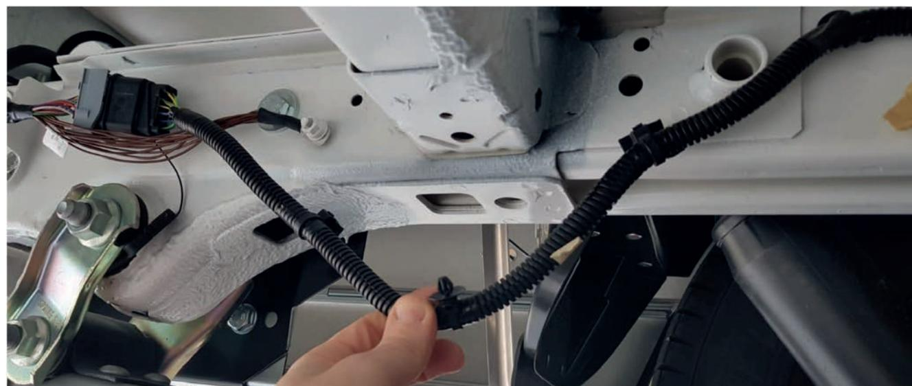
Spostare il cablaggio elettrico lateralmente, quindi inserire l'adattatore.
