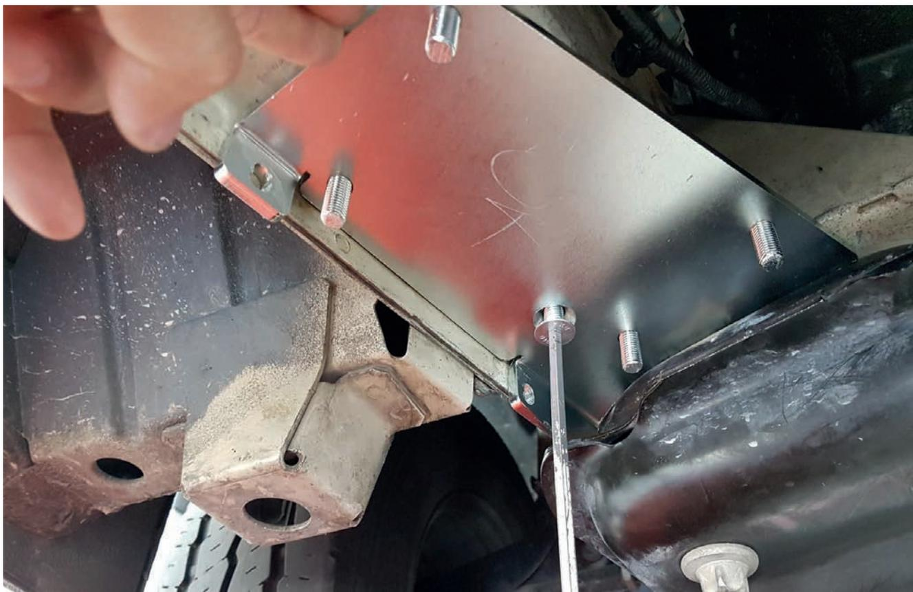
Zet de adapter vast met de montageplaat die u in het gat hebt gestoken.
