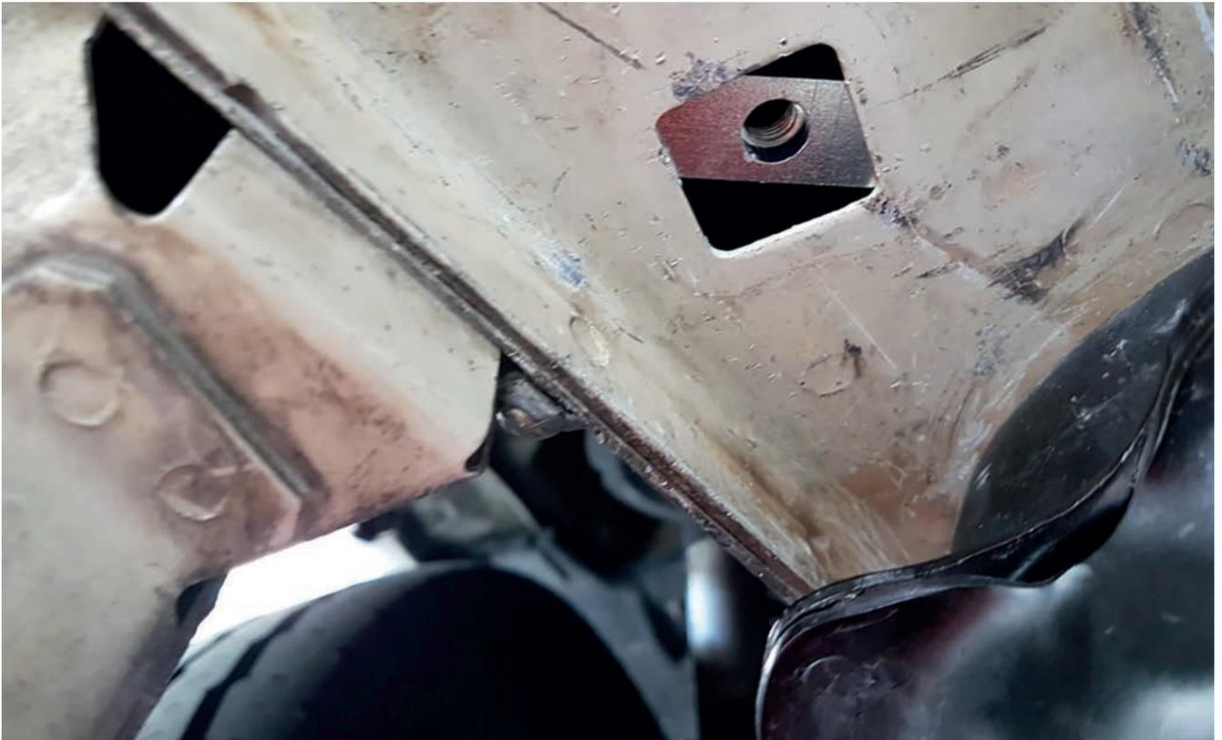
Insérez la plaque de montage avec le trou de vis concentrique au trou carré du châssis.
